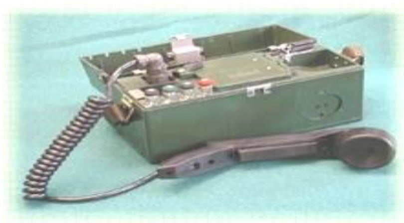
Rys. 20. Polowy aparat telefoniczny AP-82
